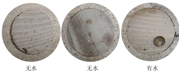
图 5 水对锚固剂的影响 Fig. 5 The influence of water
